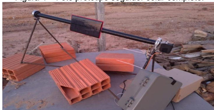
Figura 4 – Foto protótipo seguidor solar completo.
