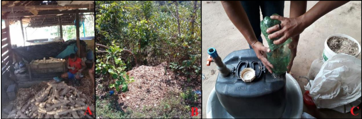
Figura 3 - Abastecimento do biodigestor caseiro com a casca de mandioca (A: descascamento da mandioca para a produção da farinha; B: armazenamento da casca da mandioca e C: abastecimento do biodigestor).
