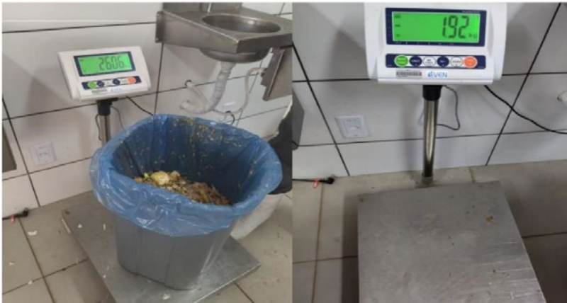
Figura 3: Balança industrial digital de bancada utilizada para pesagem de resíduos gerados.
